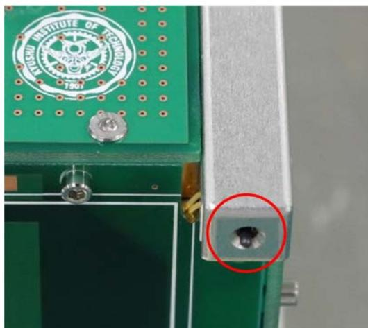
図 10 ディプロイメントスイッチ(左)©C&K;レール上のディプロイメントスイッチ(右)
