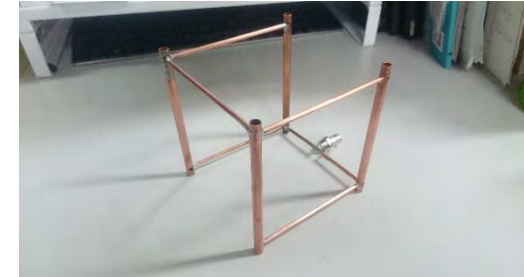
Actual Loop Hentenna Prototype
