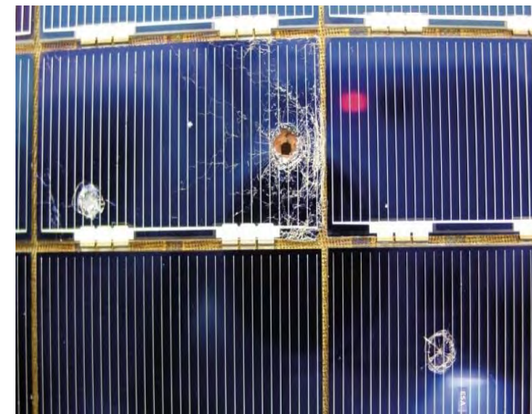
Fig. 3. Daños a paneles solares del telescopio Hubble in 2002. Fuente: ESA
